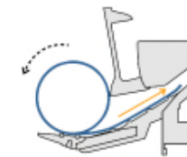
Giro del rollo en sentido inverso y el borde va al alimentador.
