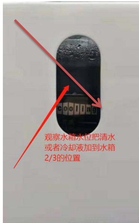
6. Chequeo del nivel de agua destilada, fundamental para enfriar la lámpara UV
