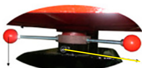
Palancas de regulación de presión
