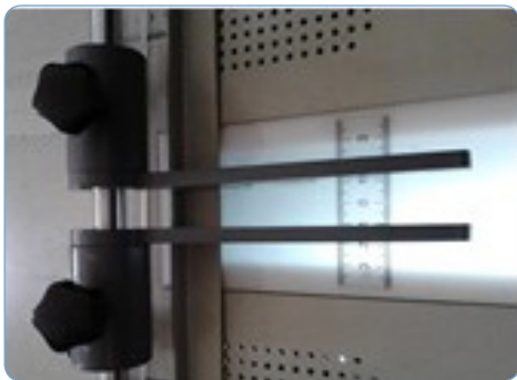
La cubierta, cartón y guía central del lomo se puede ajustar y posicionados con precisión.
