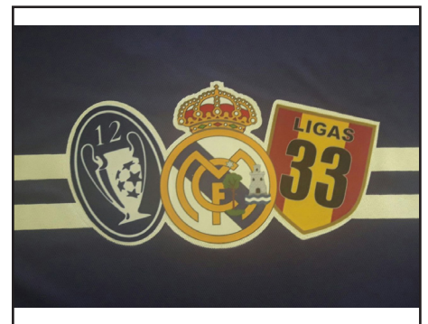
Ejemplo de sublimación transferida a Flock con impresora Sublimation Ricoh SG7110 y tintas Sublijet-R , usando papel Texprint XP . (corte con plotter GCC).
