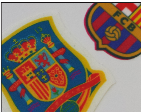
Ejemplo de sublimación transferida a Flock con impresora Sublimation T3 de 24" y tintas Sublijet-E , usando papel Texprint XP . (corte con plotter GCC)
