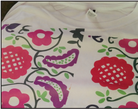
Ejemplo de camiseta para sublimación impresa con impresora Ricoh SG7110 y tintas Sublijet-R , usando papel SubliArk y Texprint XP
