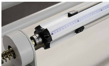
Escala milimétrica en el eje para la colocación correcta del material.
